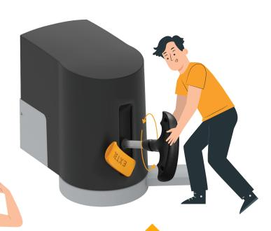
In caso di blackout è possibile aprire manualmente il cancello con la chiave per il disinnesto manuale della frizione in dotazione.
